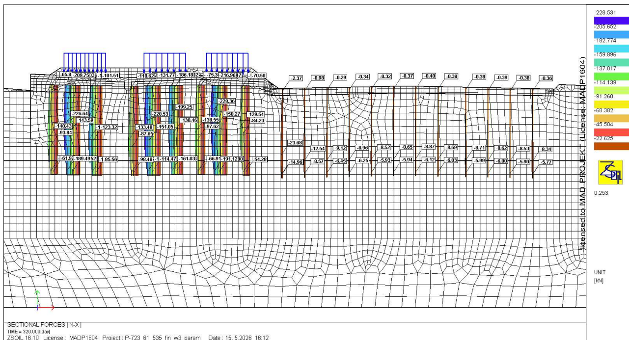
Rys. 9. Siły osiowe w palach w etapie 2 [kN].
